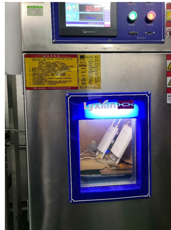
7*24小时-30°~+60°高低温循环老化测试
