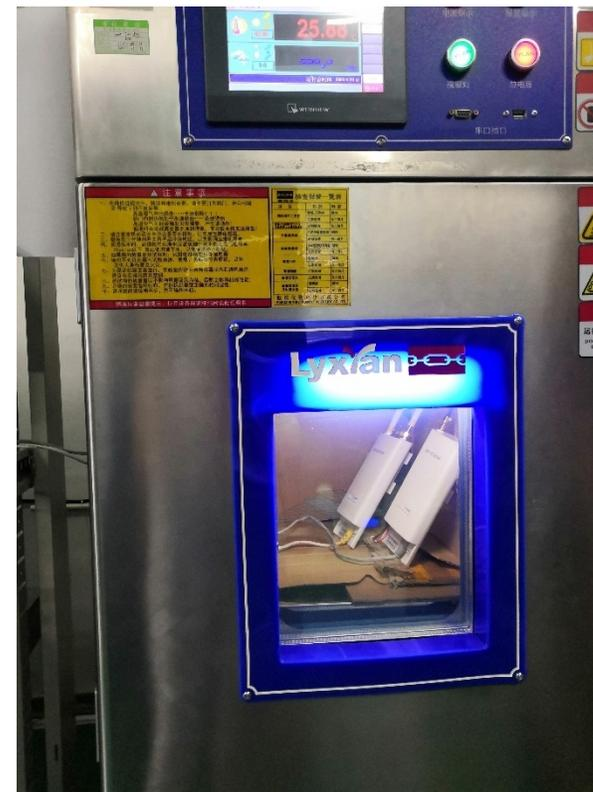
7\*24小时-30°~+60°高低温循环老化测试
